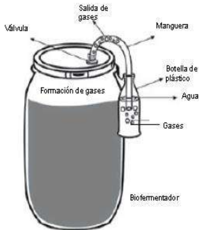
Recipiente con el biopreparado fermentando (observar burbujas de gas en la botella)
